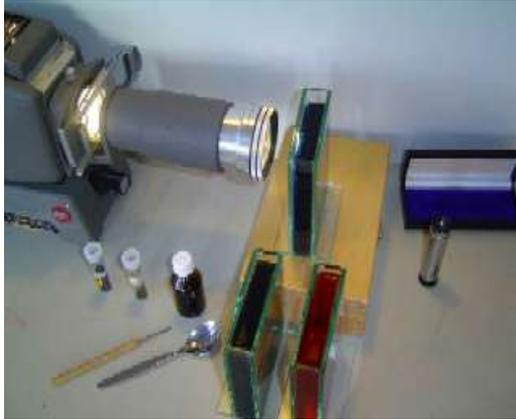
Mit einem Handspektroskop\* oder dem CD-Spektroskop lässt sich das Absorptionsverhalten der Chlorophylllösung untersuchen. Dazu gibt man die tiefgrüne Lösung in eine Küvette und bestrahlt den so entstandenen grünen Farbfilter mit einem Diaprojektor oder einer anderen möglichst hellen und weißen Lichtquelle. Ersatzweise lassen sich auch kräftige Halogenleuchten (Baustellenstrahler) verwenden. Weniger geeignet sind normale Glühlampen da deren Blauanteil in der Regel zu gering ist.
