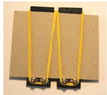
Abb. 6: Montage der Solarzellen auf einen Pappstreifen.
