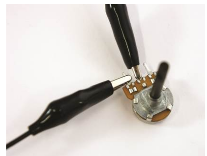
Abb. 17: Anschluss am Potentiometer über einen seitlichen Kontakt und den mittleren Kontakt.
