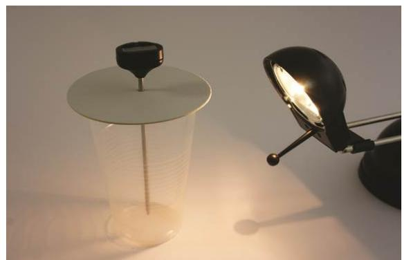
Abb. 2: Messung im geschlossenen Becher.
