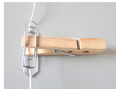
Abb. 4: Schalter aus Wäscheklammer und Büroklammern mit Schalltitze.
