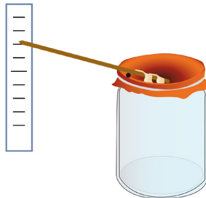
Abbildung 2: Selbst gebautes Dosenbarometer. Der schwarze Punkt markiert den Auflagepunkt (Drehpunkt).
