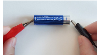
Abbildung 6: Krokodilklemmen-Kontakt durch Andrücken.
