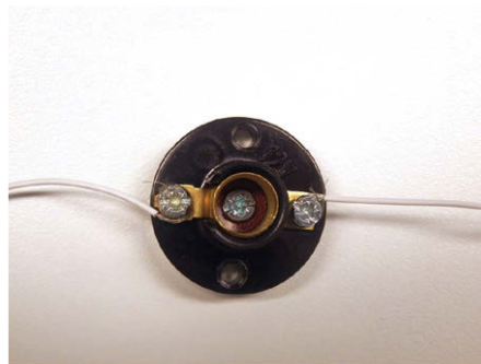
Abbildung 7: Schaltlitze, an Schraubanschluss befestigt.
