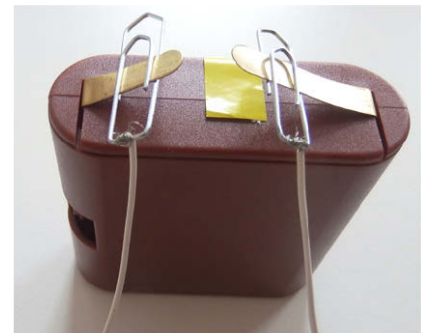
Abbildung 8: Schaltlitze, mit Büroklammer an Batteriepol befestigt.
