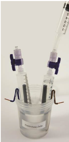
Abb. 5: Absaugen der restlichen Luft, die Zylinder füllen sich mit Sodalösung.
