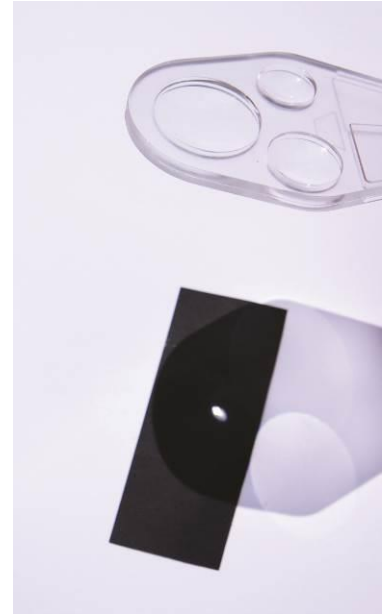
Abb. 2: Erzeugen des Brennpunkts und Entzünden des Papierstreifens.
