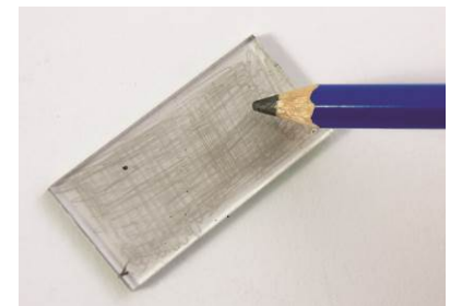
Abb. 3: Die leitfähige Seite wird mit weichem Bleistift graphitiert.
