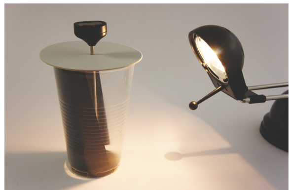
Abb. 1: Einfaches Modell eines Treibhauses: Ein Becher aus transparentem Kunststoff (Polypropylen), der mit einem Deckel verschlossen ist, und schwarzes Papier als Absorber.
