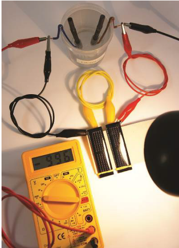
Abb. 8: Messanordnung zur Ermittlung der Mindestspannung bei der Elektrolyse mittels Solarzellen.
