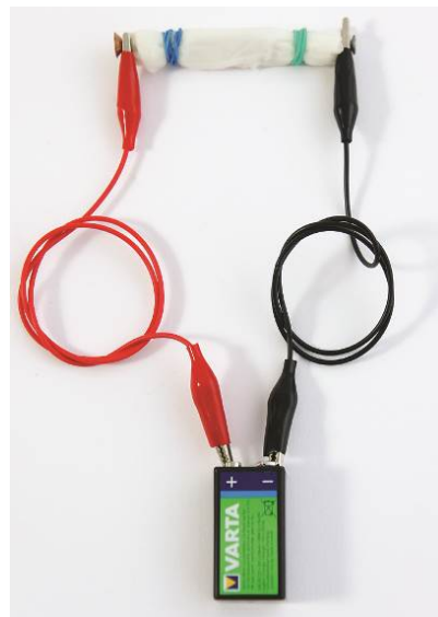
Abb. 3: Aufladen des Elektrodenpacks.
