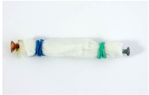
Abb. 1: Fertiger, mit Kochsalzlösung getränkter Elektrodenpack.
