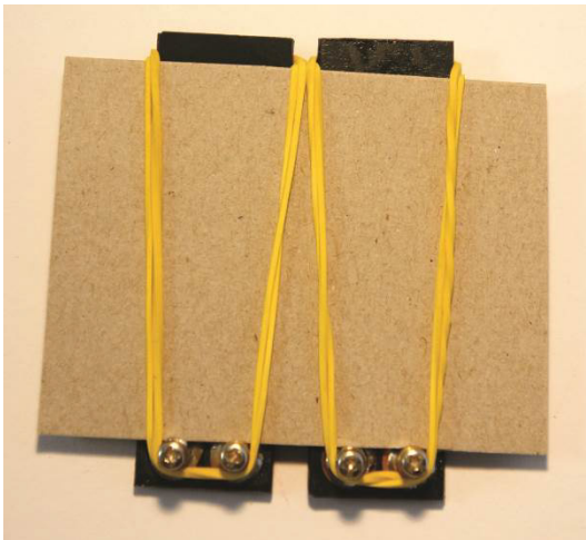
Abb. 10: Montage der Solarzellen auf einen Pappstreifen mittels Gummiband.
