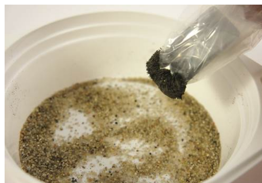
Abb. 1: Arbeiten mit dem verpackten Magneten als „Eisensauger“.
