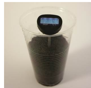
Abb. 3: Temperaturmessung im Inneren des Bechers nach Lichteinwirkung.
