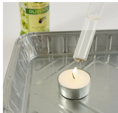
Abb. 2: Die wässrige Sodalösung wird erhitzt und dann das Öl zugegeben.
