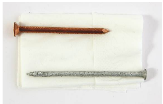
Abb. 9: Einpacken der Elektroden in ein Papiertuch.
