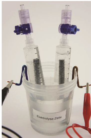
Abb. 6: Die Erzeugung von Gas nach Anschluss des Akkus.
