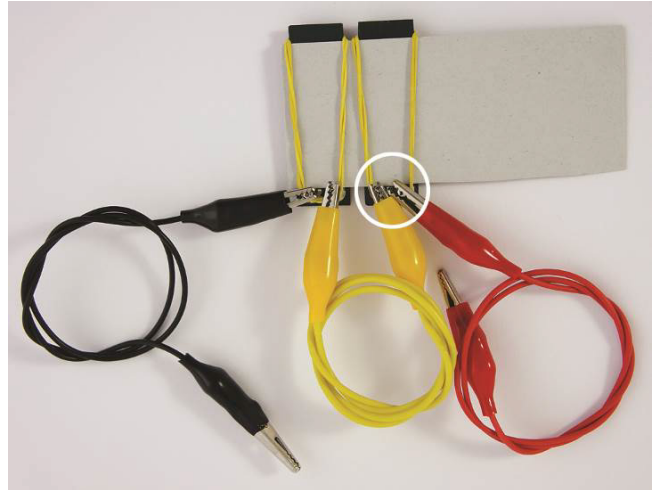
Abb. 9: Beachte, dass es beim Verkabeln nicht zum Kontakt der Krokodilklemmen und damit zu Kurzschluss kommt.
