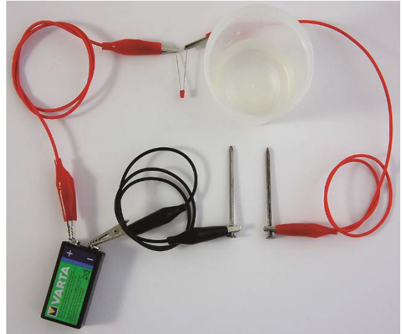
Abb. 4: Messanordnung zur Bestimmung der Leitfähigkeit.
