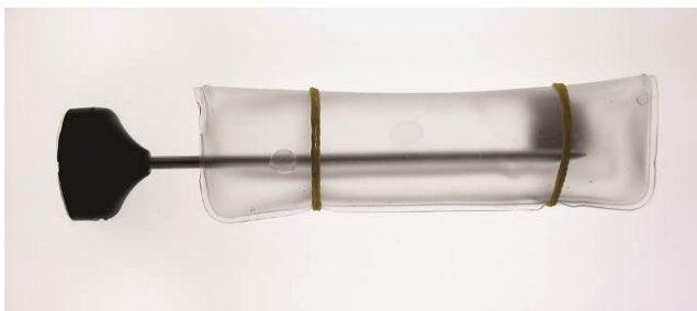
Abb. 4: Das in das gefaltete Wärmekissen eingesteckte Thermometer.
