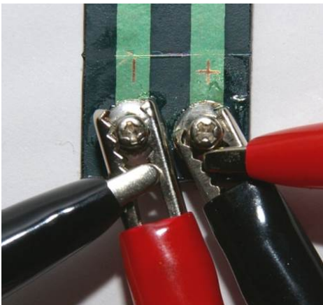
Abb. 18: Falsch: Zu viele Klemmen an einem Geräteanschlusspunkt.
