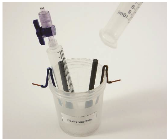
Abb. 4: Endmontage der Zelle.
