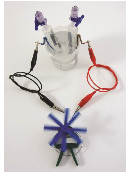
Abb. 7: Die mit Elektrolyse-Gas aufgeladene Zelle kann auch Strom abgeben.
