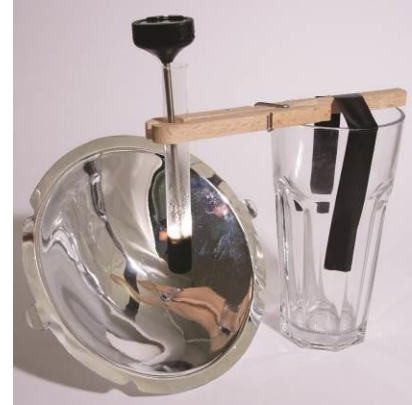
Abb. 4: Klebeband und großes, schweres Trinkglas als Stativersatz.
