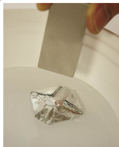
Abb. 4: Über dem Alu-Achteck wird der Magnet kreisförmig bewegt.
