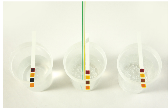
Abb. 2: Bei richtiger Durchführung ist im Gegensatz zu reinem Wasser (links) bei den Proben mit Kohlensäure (Mitte aus Atemluft, rechts Mineralwasser) eine Absenkung des pH-Werts an der Verfärbung des grünen Farbfelds zu erkennen.
