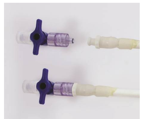
Abb. 8: Montage des Einweghahns an den Membranschlauch.
