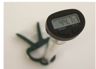
Abb. 2: Messung der Abkühlung beim unisolierten Reagenzglas.
