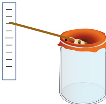
Figura 2: Barómetro aneroide auto construido. El punto negro marca el punto de apoyo (centro de rotación).
