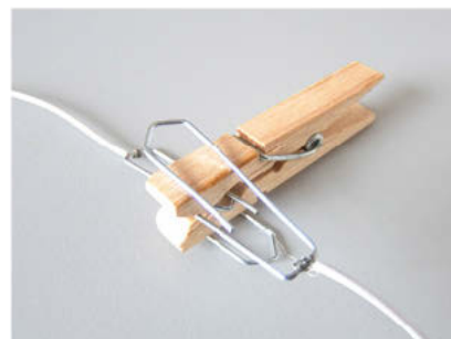
Fig. 7: Interruptor hecho de gancho para la ropa, modificado.
