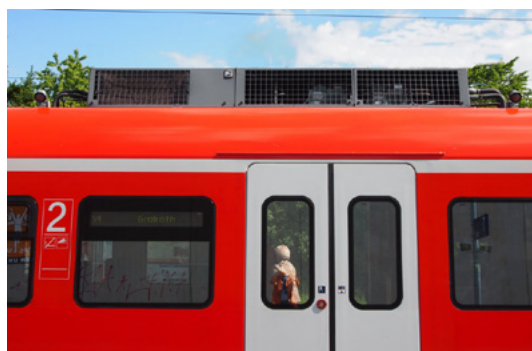
Figura 4: Aire acondicionado en el techo de un tren.
