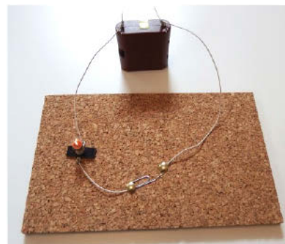
Fig. 6: Interruptor hecho de clip para papel doblado y chinchas.
