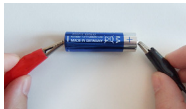
Figura 6: Contacto de pinzas cocodrilo mediante presión.
