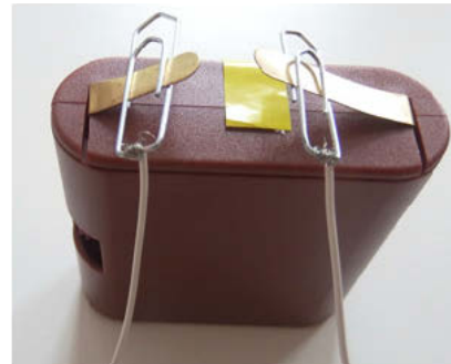
Figura 8: Cable eléctrico, asegurado al polo de la pila con clip para papel.
