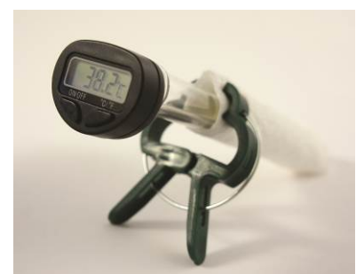
Abb. 3: Messung der Abkühlung beim durch Umwickeln mit Papiertuch isolierten Reagenzglas.
