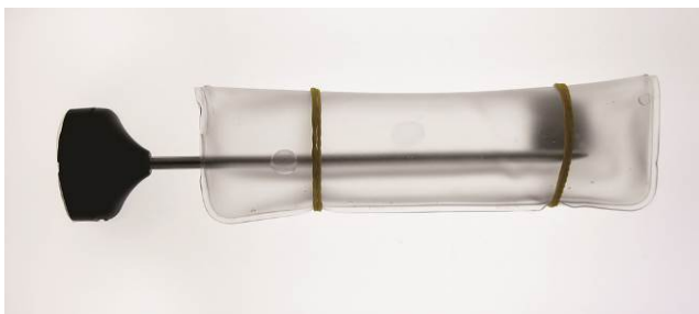
Abb. 4: Das in das gefaltete Wärmekissen eingesteckte Thermometer.
