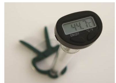
Abb. 2: Messung der Abkühlung beim unisolierten Reagenzglas.
