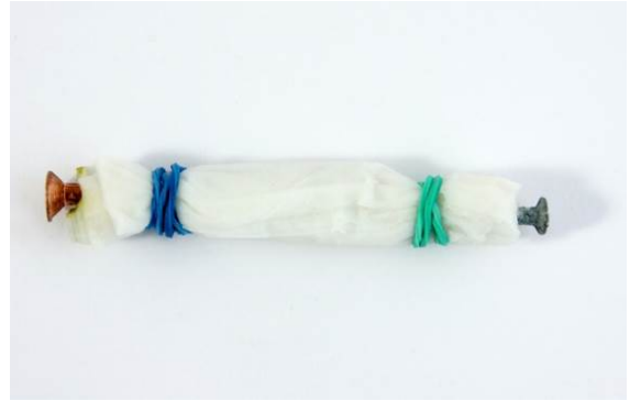
Abb. 1: Fertiger, mit Kochsalzlösung getränkter Elektrodenpack.
