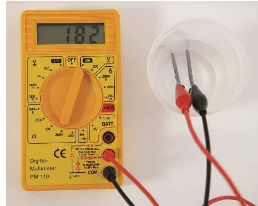
Abb. 3: Messung des Widerstands der wässrigen Lösung.
