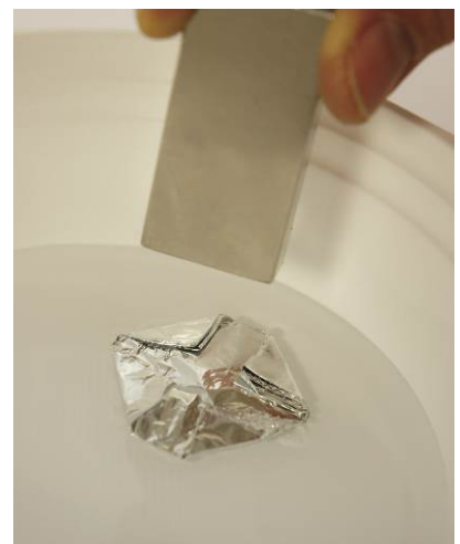
Abb. 4: Über dem Alu-Achteck wird der Magnet kreisförmig bewegt.
