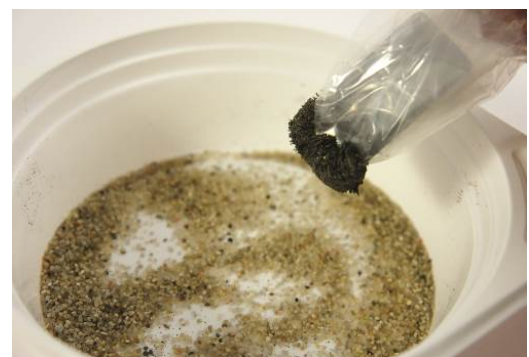
Abb. 1: Arbeiten mit dem verpackten Magneten als „Eisensauger“.
