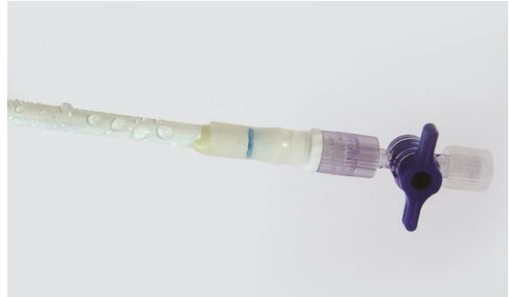
Abb. 9: An der Oberfläche des Membranschlauches austretendes Filtrat.
