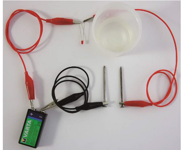
Abb. 4: Messanordnung zur Bestimmung der Leitfähigkeit.
