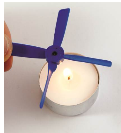
Abb. 8: Verformung des Propellers zu einem Wasserrad.
