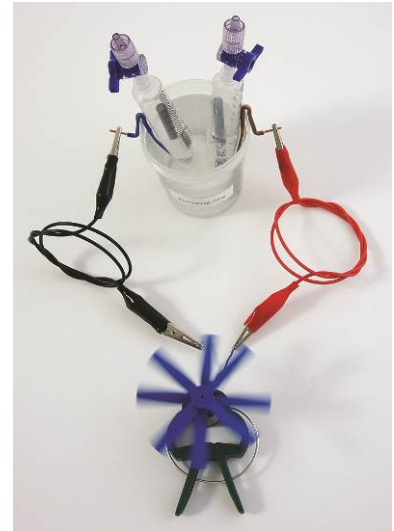
Abb. 19: Die mit Elektrolyse-Gas aufgeladene Zelle kann auch Strom abgeben.
