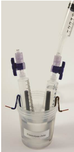
Abb. 17: Absaugen der restlichen Luft, die Zylinder füllen sich mit Sodalösung.
