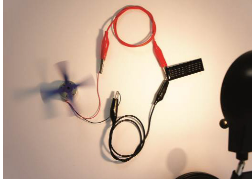
Abb. 3: Betrieb des großen Solarmotors an einer Solarzelle.
