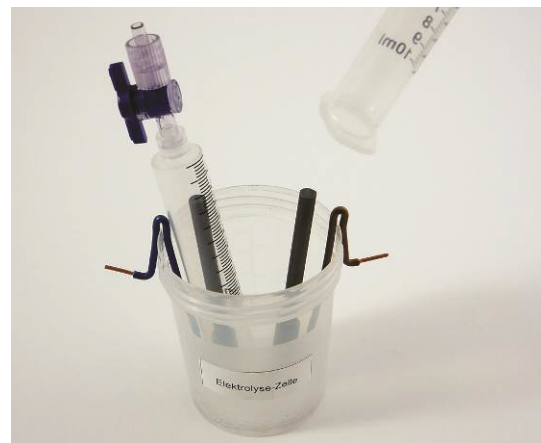
Abb. 4: Endmontage der Zelle.
