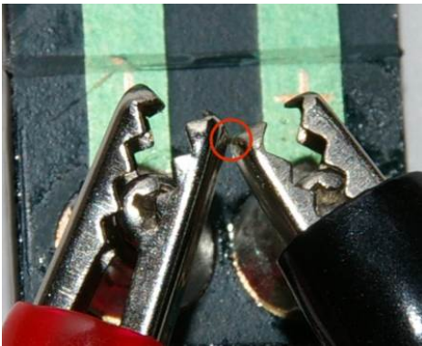
Abb. 16: Falsch: Die Krokodilklemmen berühren sich, es kommt zum Kurzschluss.
