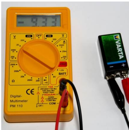
a) Der Anschluss der Messkabel am Digitalmultimeter ist inkorrekt. Es wird eine negative Spannung angezeigt.
