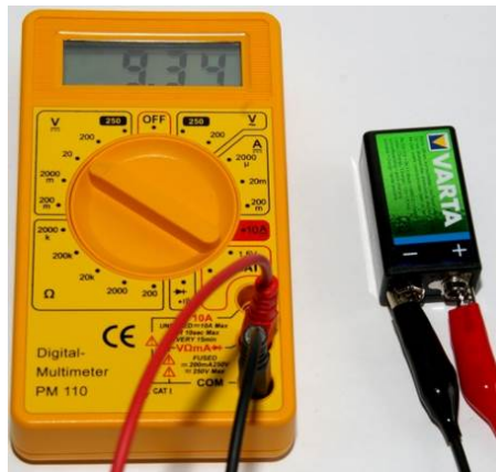
b) Der Anschluss der Messkabel an Digitalmultimeter und Akku ist korrekt. Es wird eine positive Spannung angezeigt.
