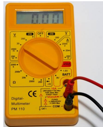
Abb. 4: Richtiger Anschluss der Messkabel an das Digitalmultimeter.
