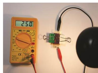
Fig. 6: Determinar la tensión en vacío bajo una lámpara halógena.
