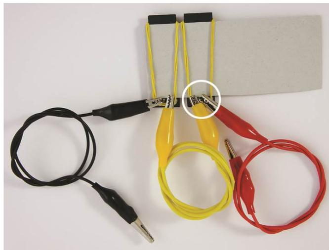
Fig. 9: Presten atención para que al poner los cables no entren en contacto las pinzas de cocodrilo y que se produzca entonces un cortocircuito.
