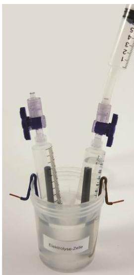
Fig. 5: Absorban el aire restante, los cilindros se llenan con la solución sódica.
