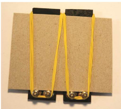
Fig. 10: Montaje de las células solares en una tira de cartón con una banda elástica.
