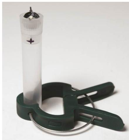
Fig. 11: El condensador de doble capa con la fijación.
