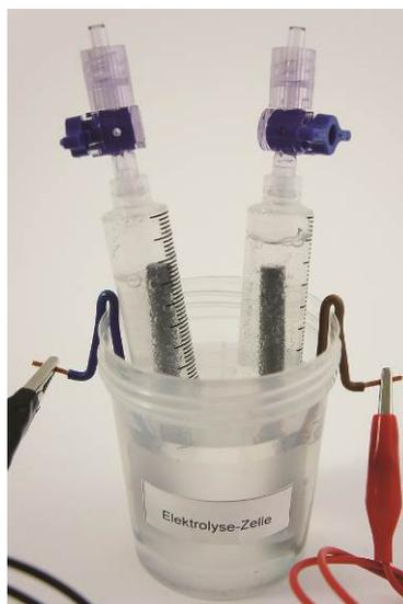
Fig. 6: La formación de gas tras conectar la pila.
