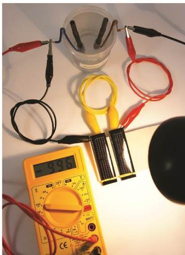
Fig. 8: de Medición para determinar la tensión mínima en la electrólisis con células solares.
