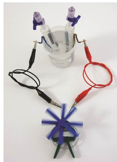
Fig. 7: La célula cargada con el gas de la electrólisis también puede generar corriente eléctrica.
