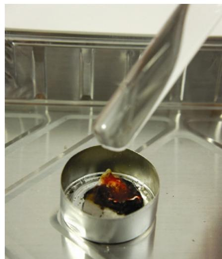
Fig. 3: El tubo de ensayo frío sobre la llama del azúcar.
