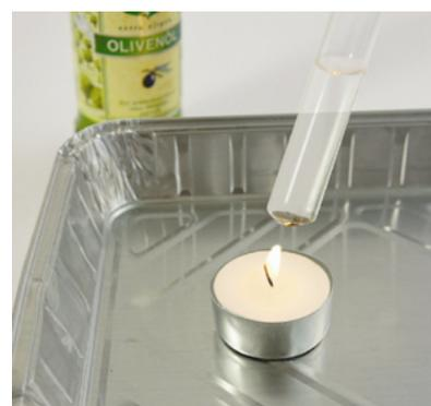
Fig. 2: La solución acuosa de carbonato de sodio se calienta y luego se añade el aceite.
