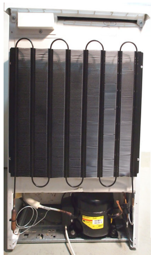
Abbildung 2: Der Kühlschrank von hinten. Man sieht die Rohrschleifen für das Kältemittel und die „Kühlrippen“ sowie den Kompressor (unten).
