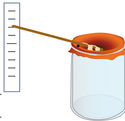
Abbildung 1: Selbst gebautes Dosenbarometer. Der schwarze Punkt markiert den Auflagepunkt (Drehpunkt).
