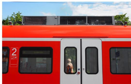
Figura 4: Aire acondicionado en el techo de un tren.
