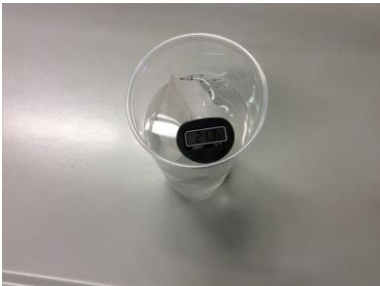
Messen der Temperatur des Wassers beim Erwärmen mit einem Wärmekissen.
