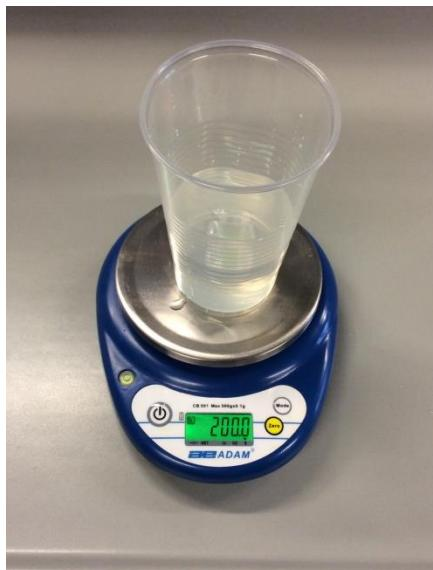
Fülle in dein Kalorimeter eine bestimmte Masse Wasser.
