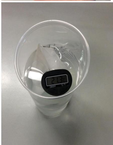
Lege das Wärmekissen in das Kalorimeter und bestimme nach 10 Minuten die Temperatur. Notiere die Werte in deinen Aufzeichnungen.
