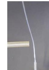
Ausgangspunkt für die Ablenkung ist das geriebene Plastiklineal.
