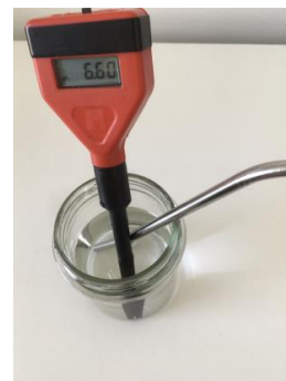
pH-Wert-Messung nach dem Pusten.
