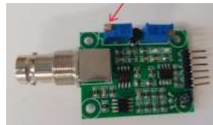
Abb. 2: Schraube, die am pH-Sensor gedreht werden muss.
